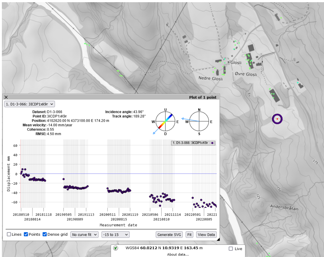
Fig. 1. Skjermutsnitt hentet fra https://insar.nqu.no/ hvor vi har zoomet inn på områder rundt Glosli. Som man kan se, er det interpolasjonspunkt i området som viser systematisk utglidning som henter om geoteknisk ustabilitet. Interpolasjonspunktet markert med blå ring har siden 2018 glidd ut mer enn 60 cm.
